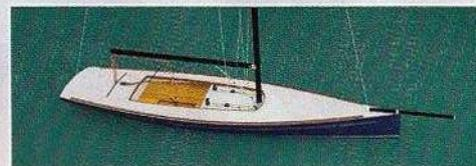
**New Miller 001. Longueur : 8,30 m. Largeur : 2,08 m. Dépl. : 1 000 kg. Lest : 450 kg. TE : 1,20/2 m. SV au près : 41 m<sup>2</sup>. Génois : 19 m<sup>2</sup>. GV : 19 m<sup>2</sup>. Spi asymétrique : 60 m<sup>2</sup>. Matériau : sapelli. Architecte : Paolo Bua.**
